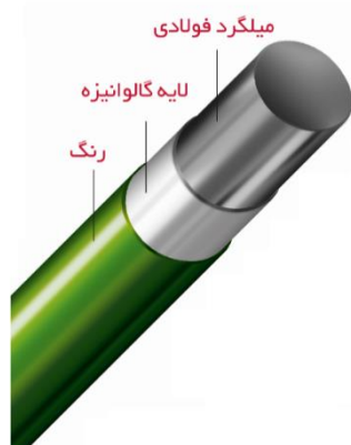
شکل ۱- جزئیات پوشش مفتول نوع ۴
